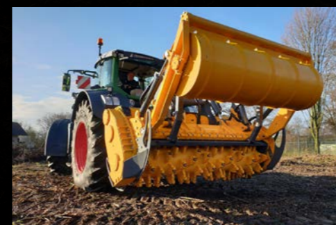
MJFS на расчистке участка под застройку
