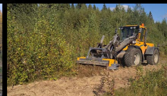
Гидравлический MC5 установленный на компактный погрузчик
