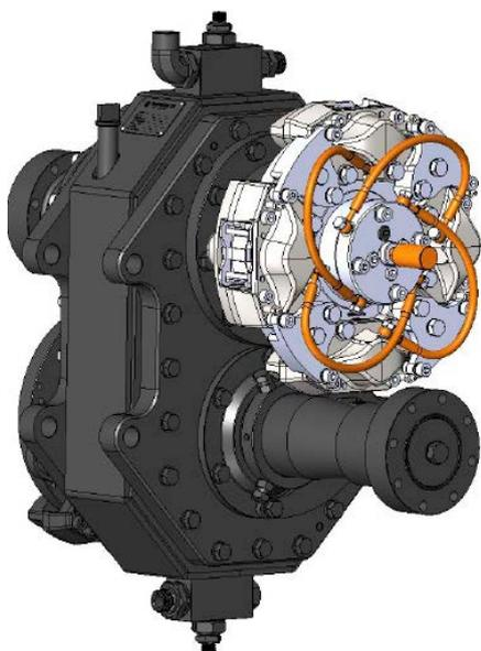
← Изготавливаемая Суоконе коробка ВОМ специально сконструирована для безопасной передачи высокого крутящего момента. Интегрированная с коробкой ВОМ предохранительная муфта РОС срабатывает при перегрузке. Система АРТОР отключает ВОМ при заранее заданном % проскальзывания.
